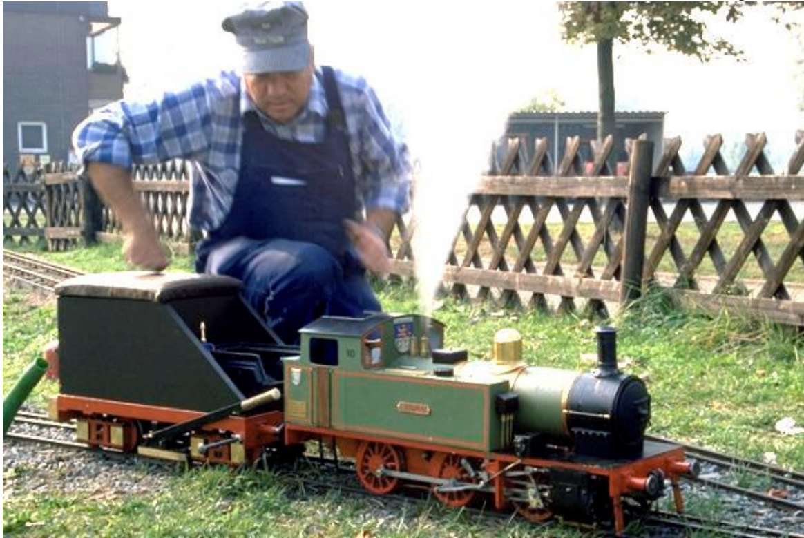
Figure 2 : La machine et son tender avec ses Boggies
