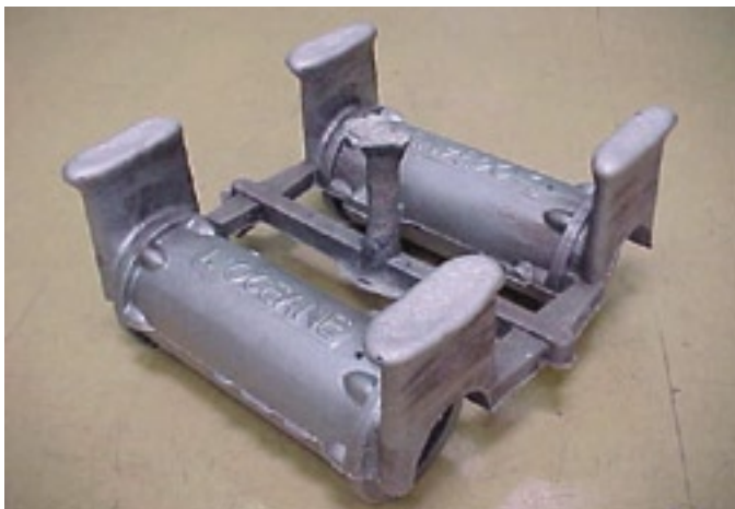
▲ Figure 8. Le résultat de la coulée
